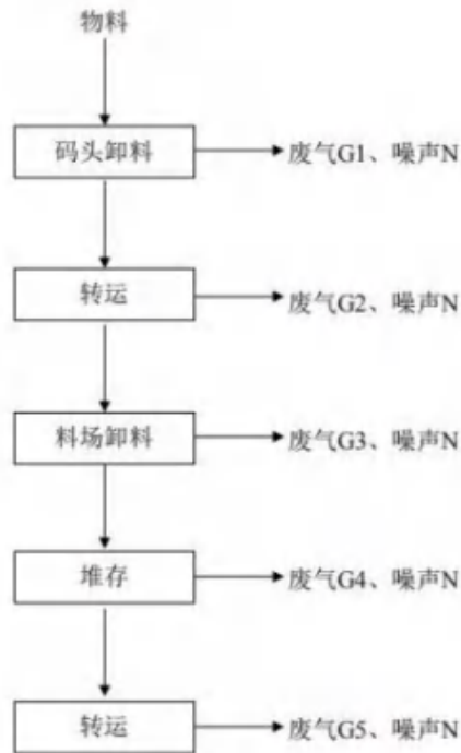
图 2.4-1 料场工艺流程图及主要产污环节
